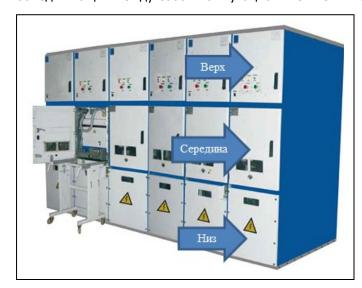
верхних отсеках шкафов КРУ. Здесь сопровождают частичные разряды возникновение различных внутренних дефектов опорных изоляторов поверхностное загрязнение внешних путей утечки изоляторов. Частичные разряды с максимальной амплитудой регистрируются в верхнем отсеке ячейки, вблизи которой возник дефект соединительных шинах.
