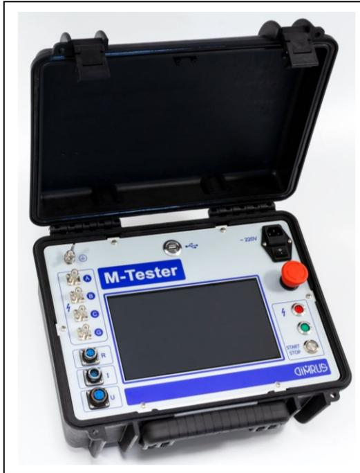
Измерения и анализ параметров работающей электрической машины называются динамическими испытаниями, проводимыми в режиме онлайн.
