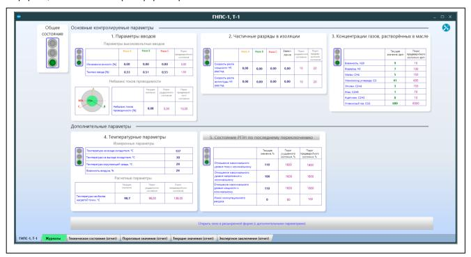
Вся необходимая информация о работе трансформатора, как первичная, так и специально обработанная экспертными программами в модулях, отображается на экране компьютера АРМ в цифровом значении и в виде стандартных светофоров состояния - «зеленый», «желтый», «красный», предназначенных для оперативного персонала.
