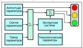
Алгоритм принятия оперативного решения о текущем состоянии трансформатора в системе TDM иллюстрируется рисунком.
